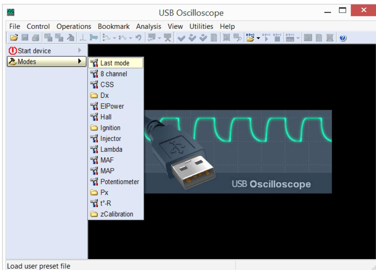
Меню "Режимы" позволяет вызывать как предустановленные режимы работы прибора, так и созданные пользователем самостоятельно.
