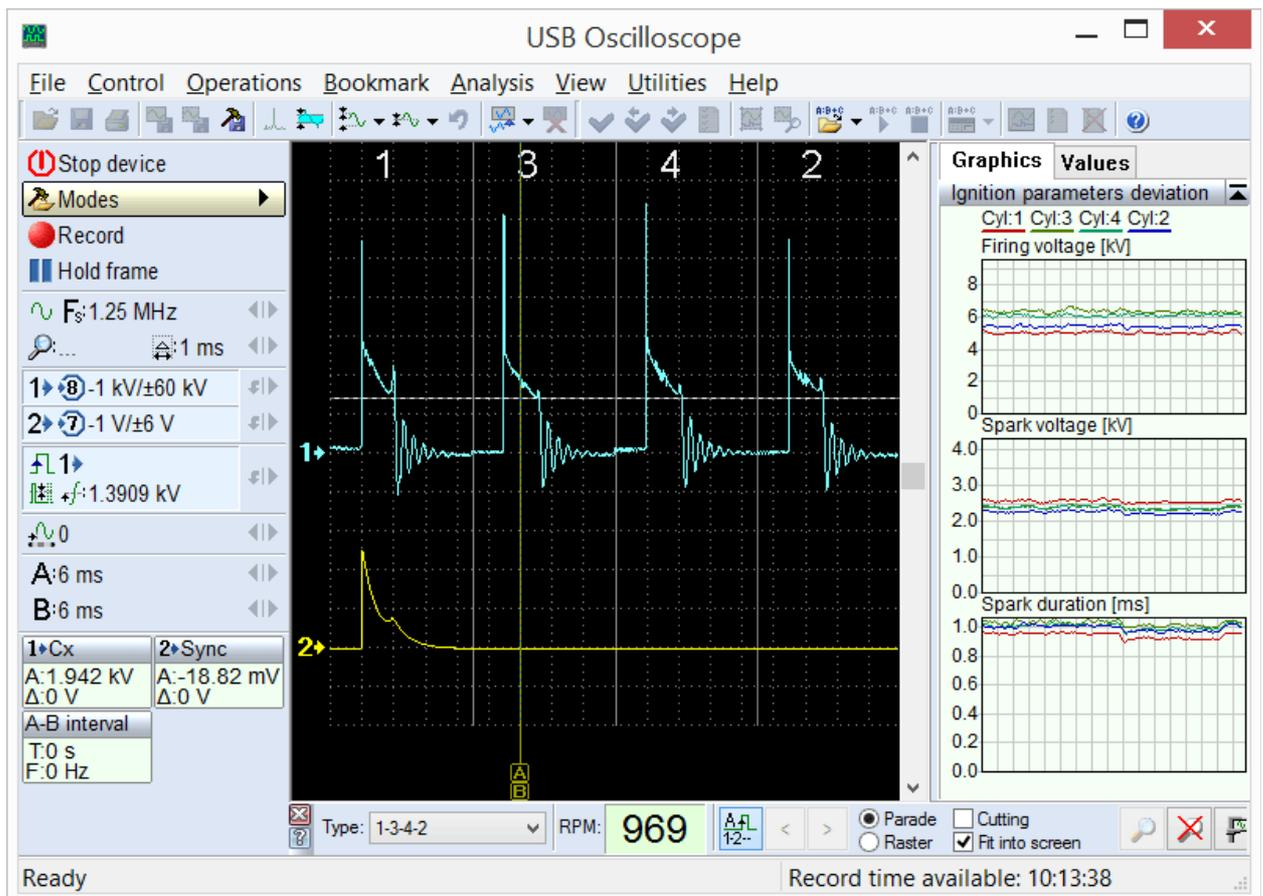
PlugIn "Диагностика зажигания", режим "Парад цилиндров".
