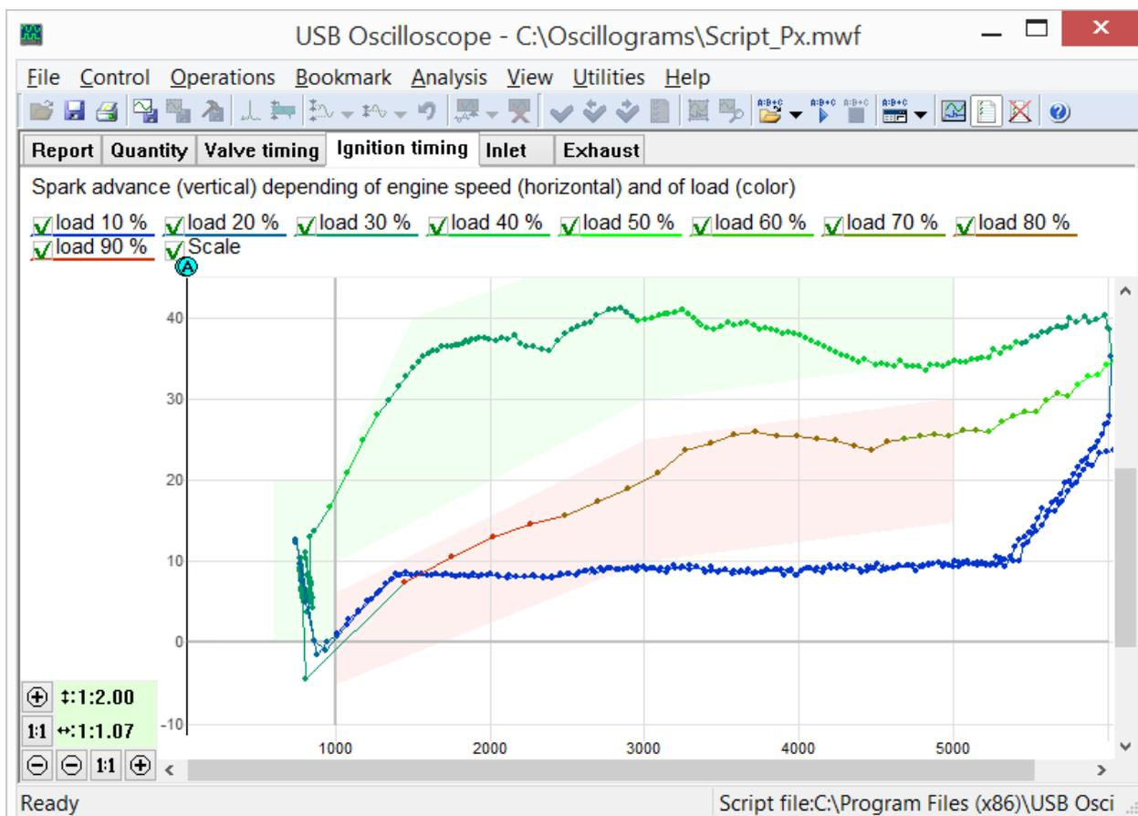
Вкладка "Опережение" из отчёта скрипта Rx. Отображает диаграмму зависимости УОЗ от оборотов двигателя и от нагрузки.
