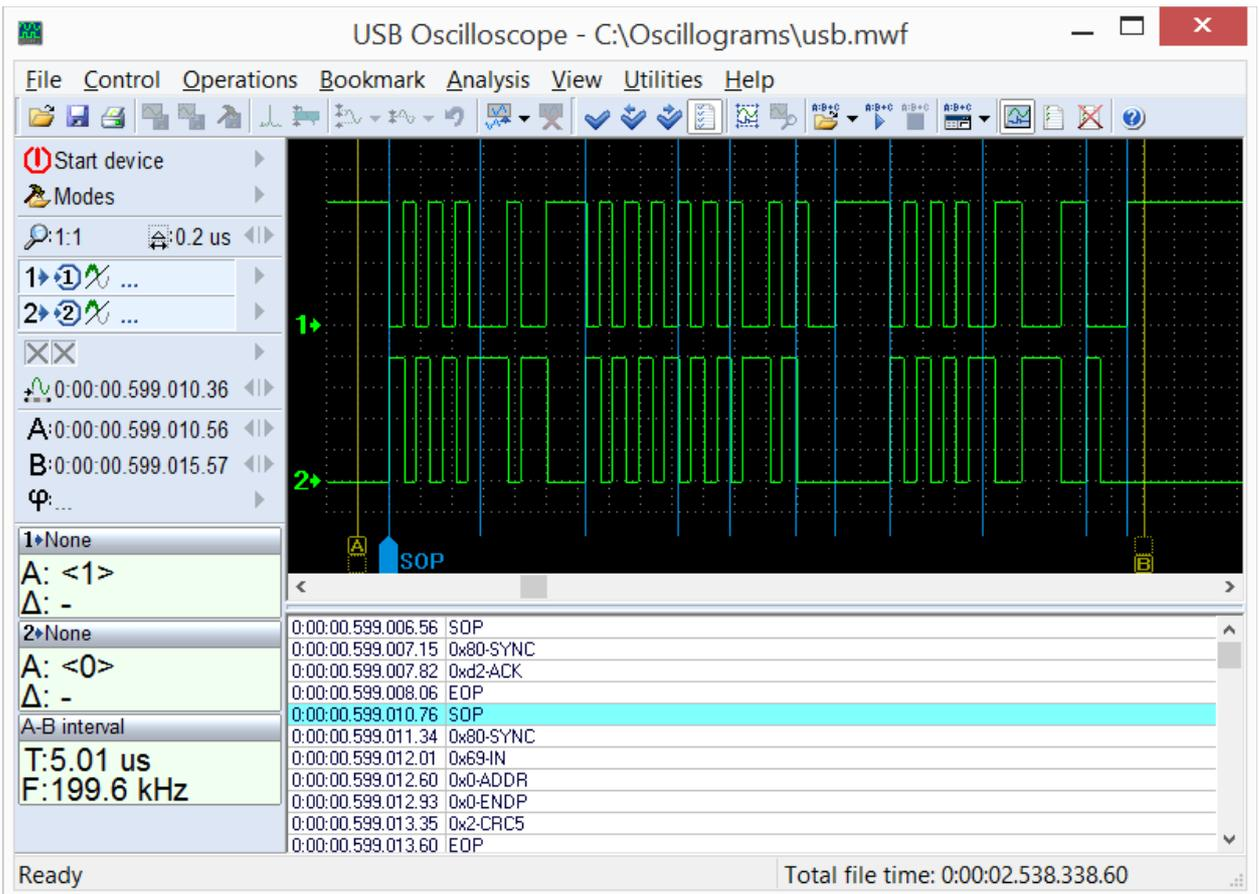
Осциллограммы USB шины, промаркированные скриптом анализатора USB2.
