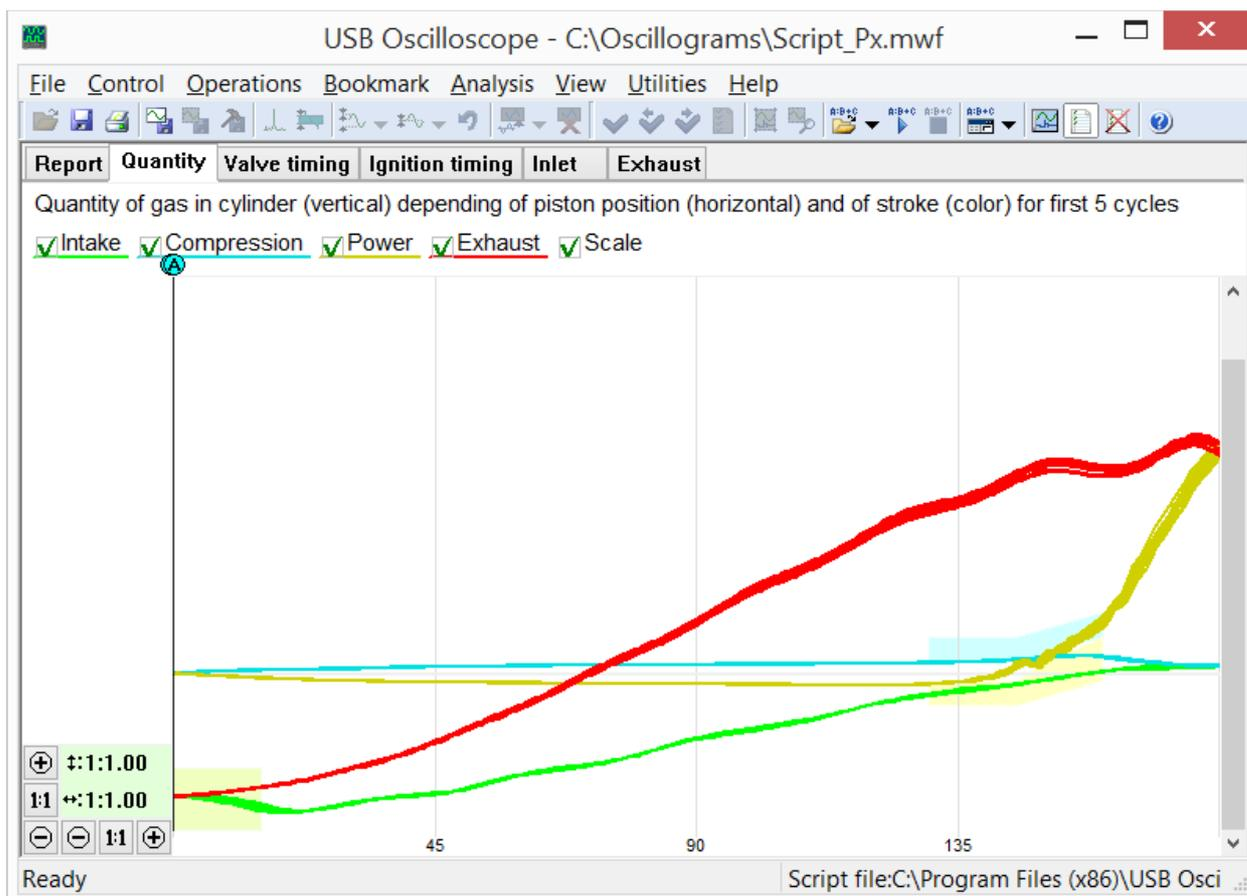
Вкладка "Количество" из отчёта скрипта Px отображает количество газа в цилиндре в зависимости от положения поршня исследуемого цилиндра и от такта его работы.
