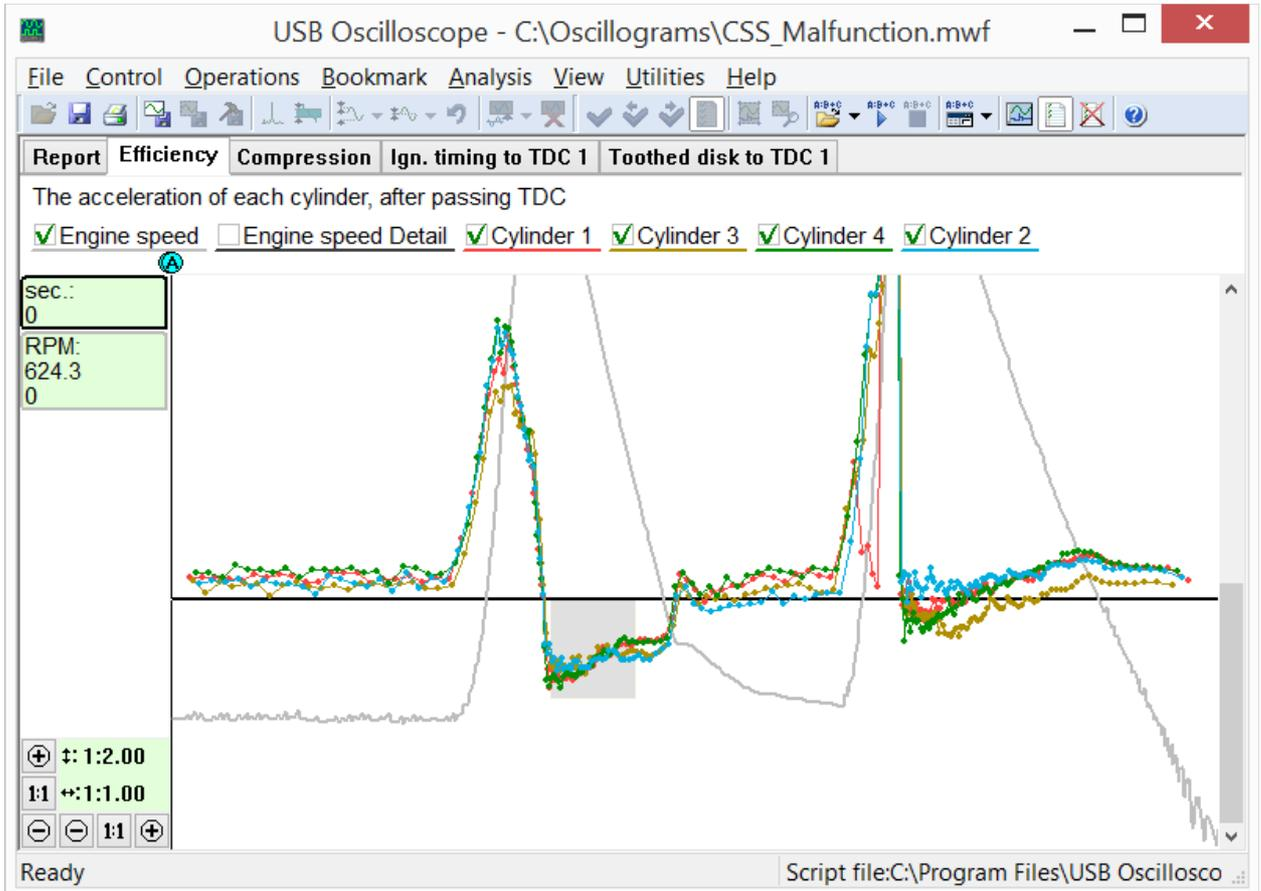
Вкладка "Эффективность" из отчёта скрипта CSS отображает графики эффективности цилиндров на различных режимах работы двигателя. В данном случае в цилиндре №1 под нагрузкой возникли пропуски искрообразования из-за неисправности в системе зажигания, а в цилиндре №3 ухудшена динамическая компрессия.
