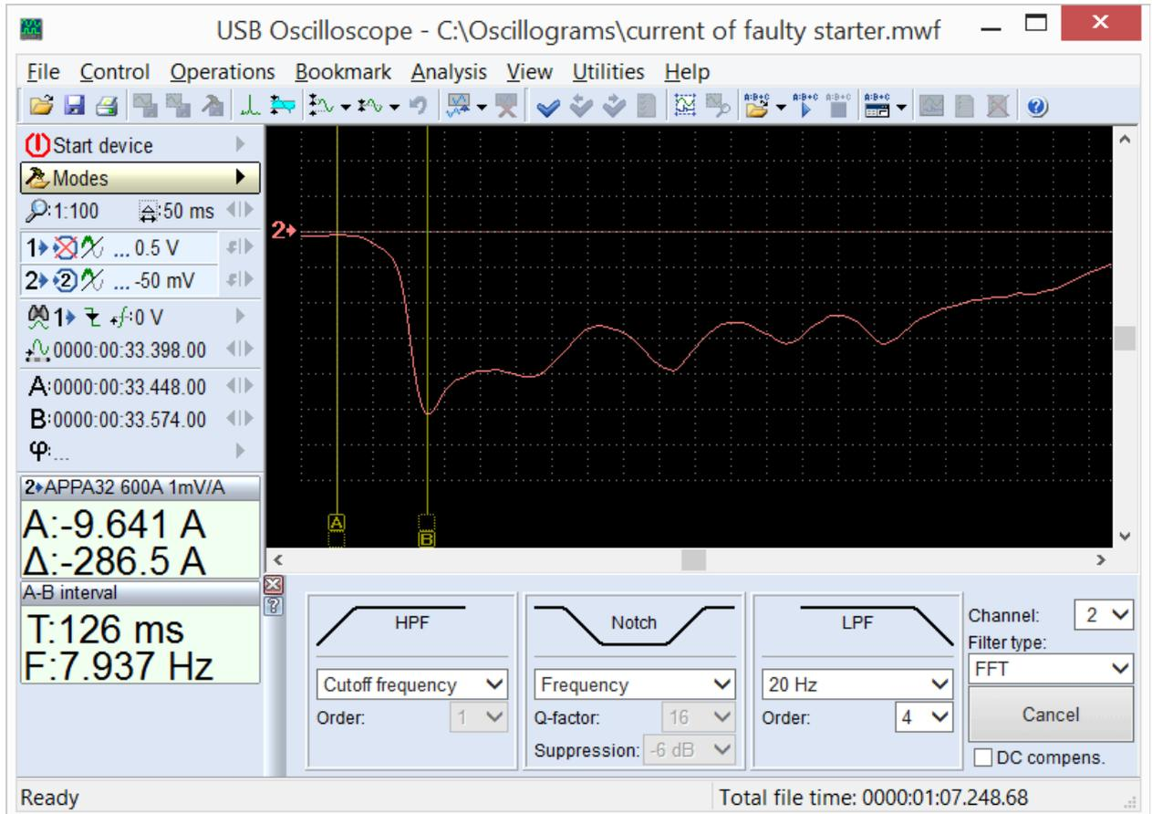
К изначально зашумленной осциллограмме применён программный фильтр низких частот при помощи панели анализатора *SoftwareFilter\_Panel*.
