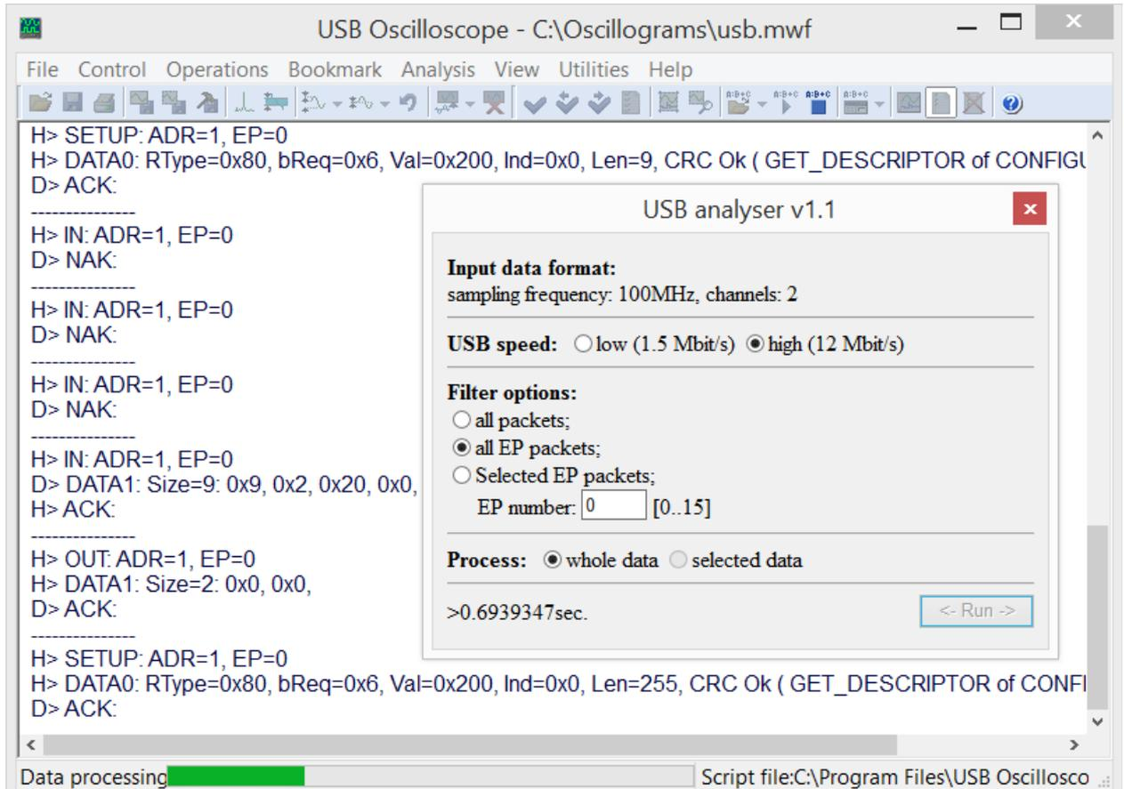
*Окно конфигурации на фоне генерируемого окна отчета в процессе анализа осциллограмм USB шины.*
