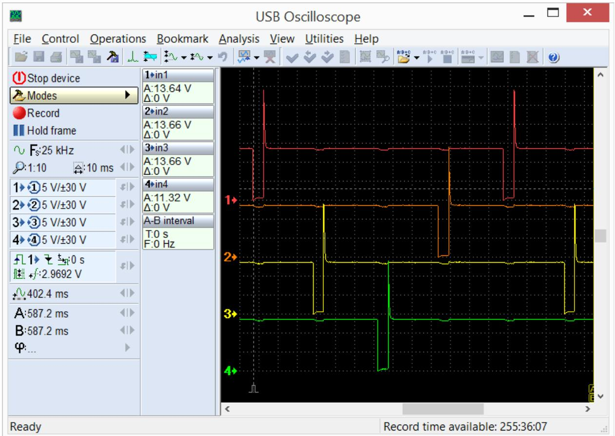
*В современных системах управления двигателем, импульсы управления бензиновыми форсунками разнесены во времени. Из-за этого, сравнение их формы и длительности затруднительно.*
