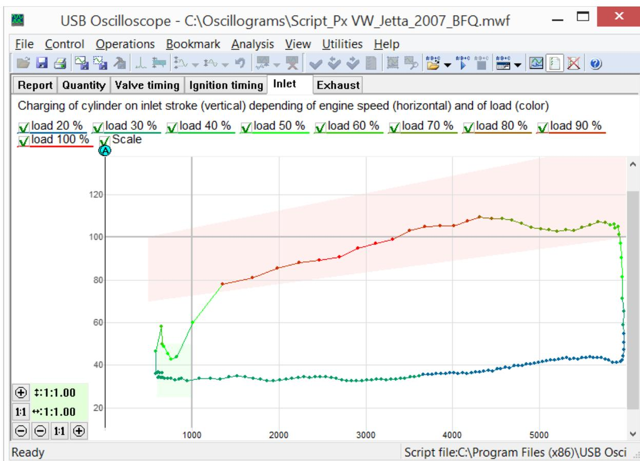
Вкладка "Впуск" из отчёта скрипта Px. Отображает диаграмму наполнения цилиндра в зависимости от оборотов двигателя и от нагрузки.
