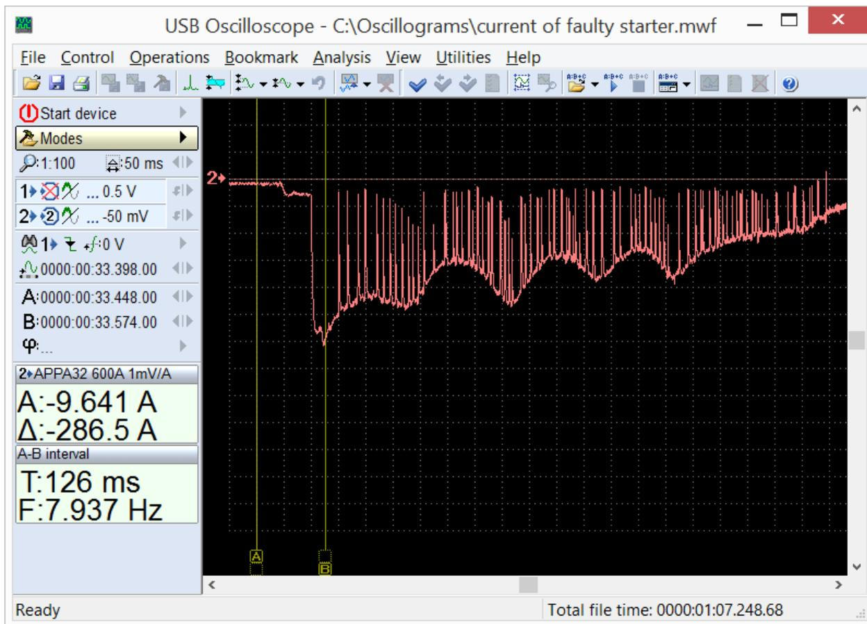
График тока неисправного стартера. Здесь из-за ненадёжного контакта щёток, многократно возникали разрывы тока, и график получился зашумленным. Для его дальнейшего исследования здесь целесообразно применение программного фильтра низких частот.
