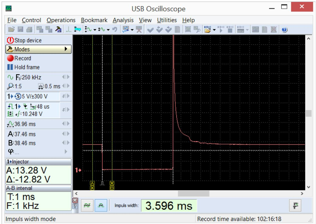
PlugIn "Временные параметры", режим "Длительность импульса".
