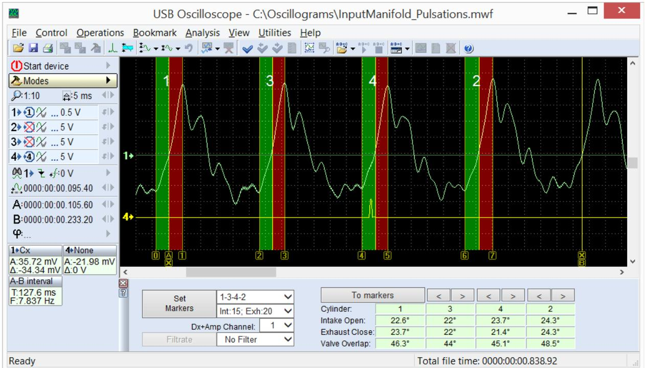
*График пульсаций разрежения во впускном коллекторе работающего на холостом ходу бензинового двигателя, исследуемый при помощи панели анализатора Dx\_Panel.*
