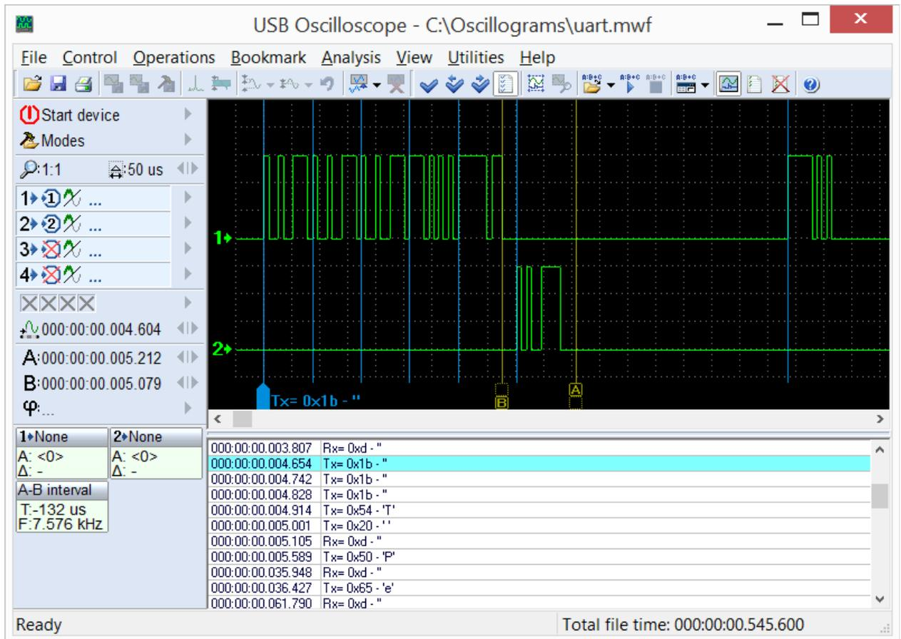
*RS232 осциллограммы, промаркированные скриптом анализатора UART.*
