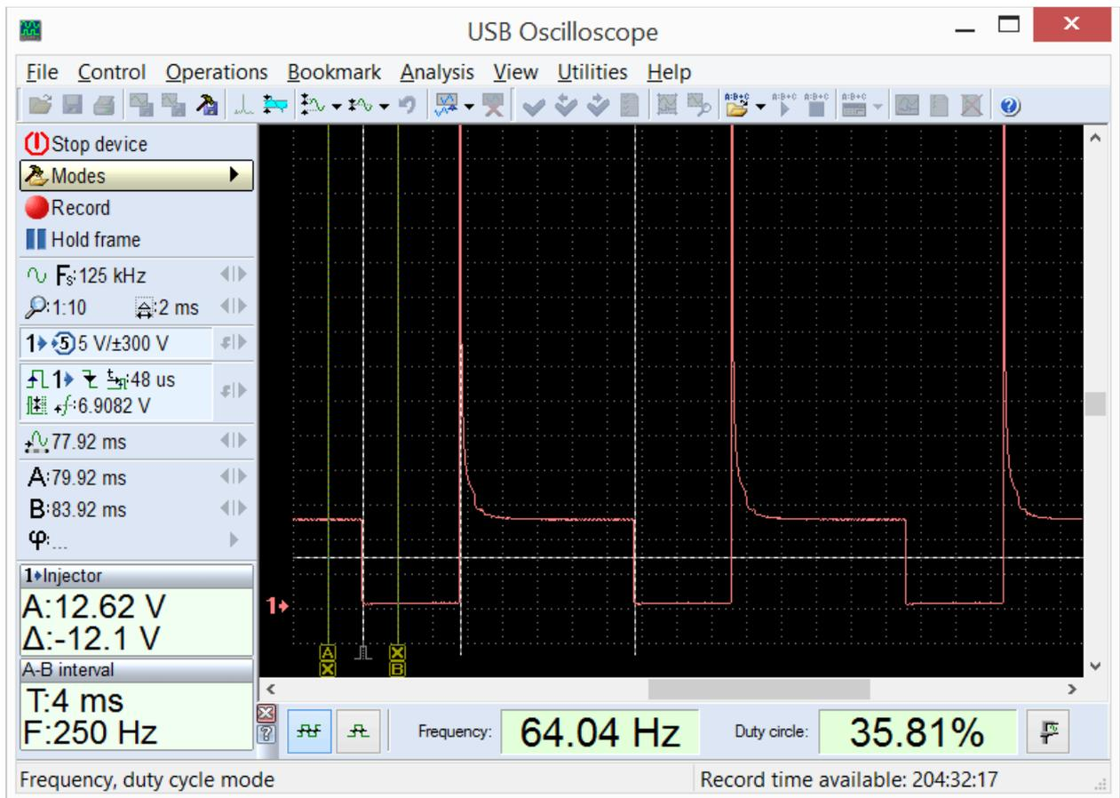
PlugIn "Временные параметры", режим "Скважность, Частота".
