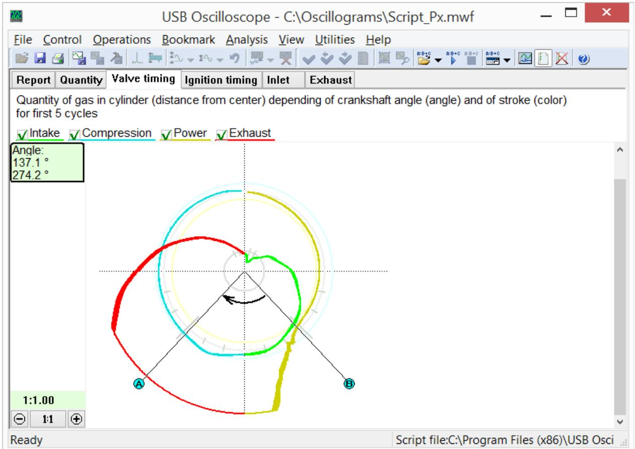
Вкладка "Фазы газораспределения" из отчёта скрипта Px отображает количество газа в цилиндре в зависимости от угла поворота коленвала.
