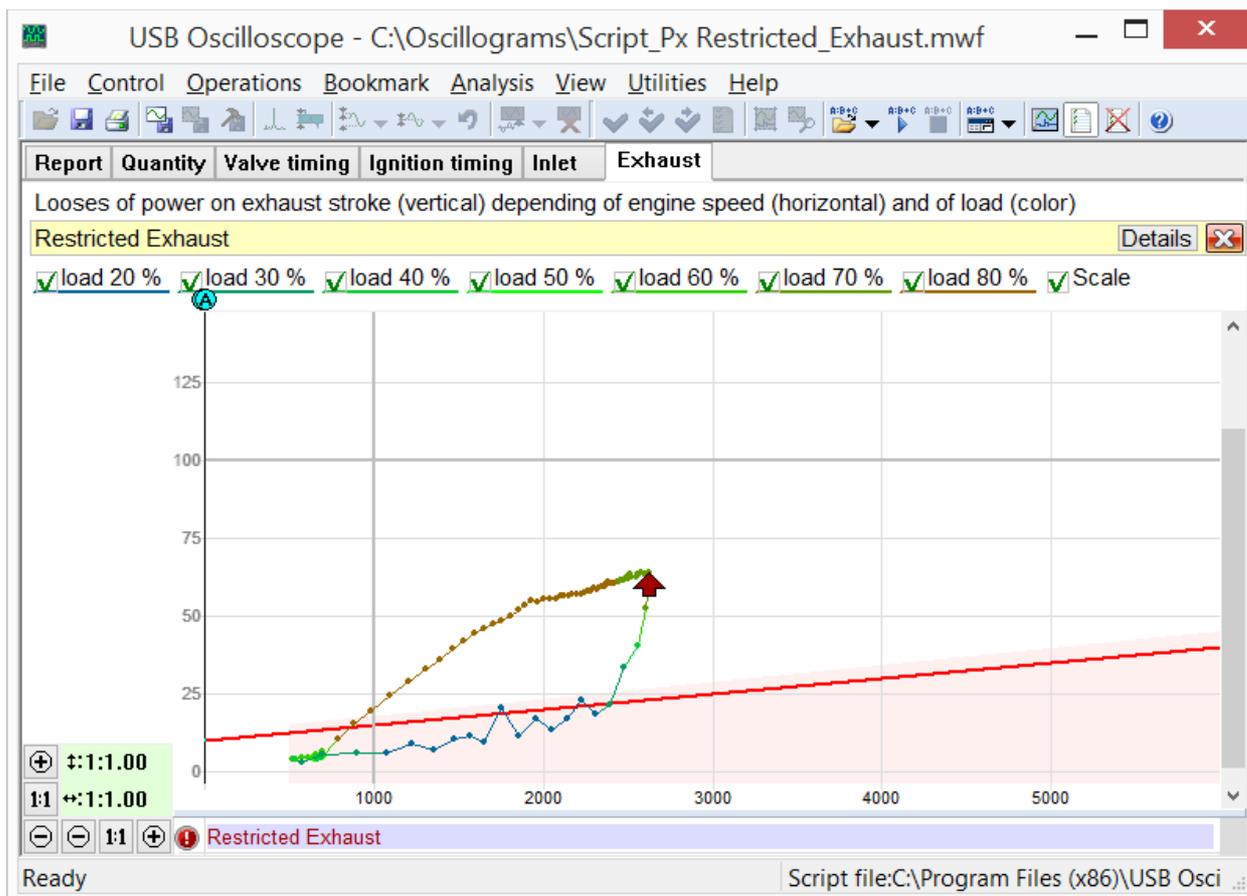
Вкладка "Выпуск" из отчёта скрипта P<sub>x</sub>. Отображает потери мощности в зависимости от оборотов двигателя и от нагрузки, затрачиваемой на очистку цилиндра от отработавших газов.
