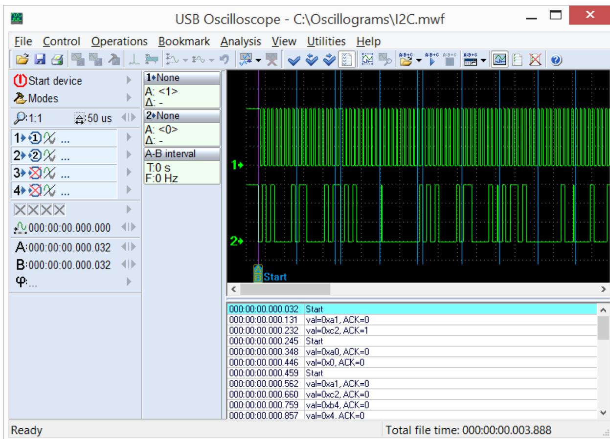
Осциллограммы сигналов интерфейса I<sup>2</sup>C, записанные в режиме логического анализатора и промаркированные скриптом анализатора I2C.
