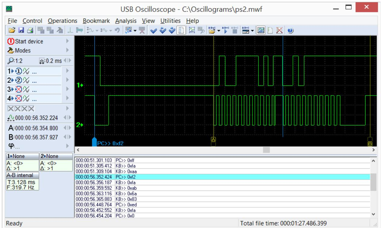
*Промаркированные скриптом анализатора PS2 осциллограммы.*
