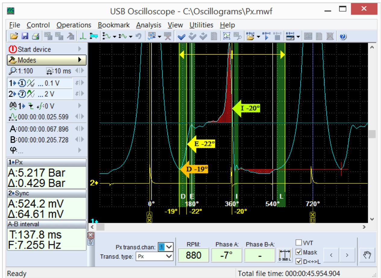
Результаты анализа графика давления в цилиндре при помощи панели Px\_Panel. Обнаруженные нарушения формы и расположения характерных точек и участков графика автоматически отмечены панелью при помощи указателей.
